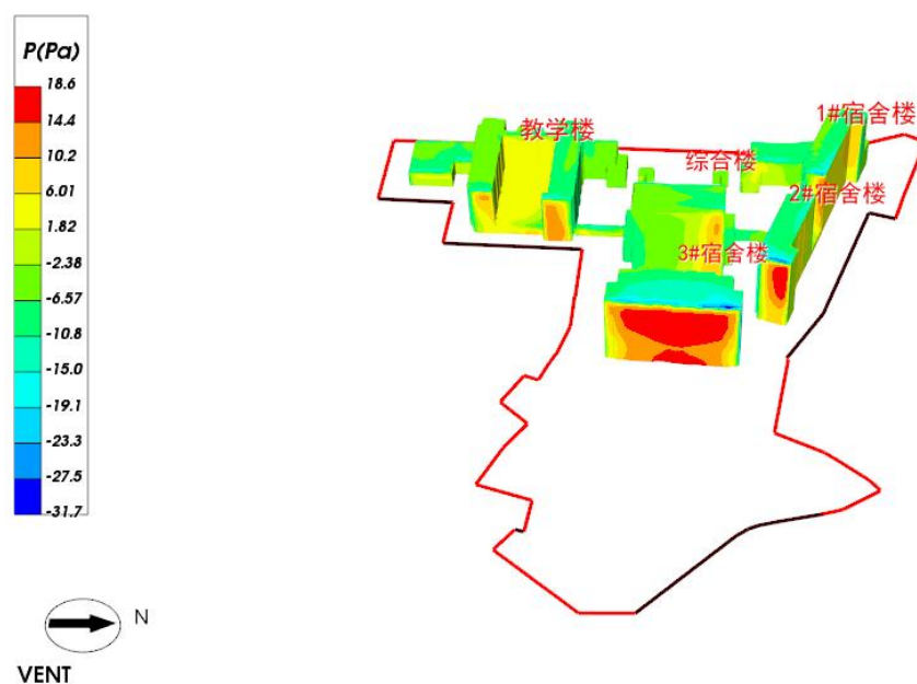
图 1.1- 2 建筑迎风面风压云图
